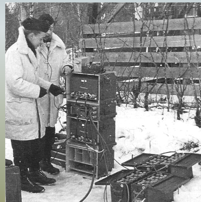
Radiolänkutrustning RL-01 i rörligt utförande under en vinterövning i Dalarna 1953.
